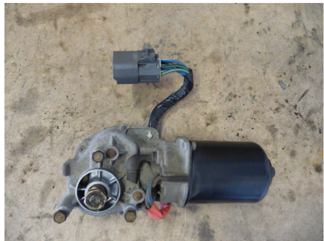
شکل ۶: الکتروموتور با نام تجاری Wiper Engine (WM-8245-2S)
