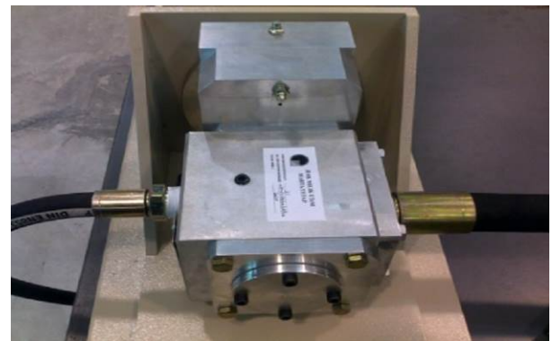
شکل ۲: میکروتوربین شرکت آمریکایی PSI Automation استفاده شده در
