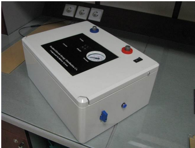
شکل ۵: نمای جانبی باتری هوای فشرده ساخته شده در شرکت توزیع برق شهرستان مشهد
