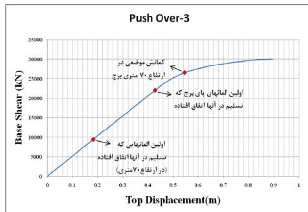
شکل ۷: منحنی نیرو-تغییر مکان برای حالت توزیع بار متناسب با جرم در ارتفاع برج
